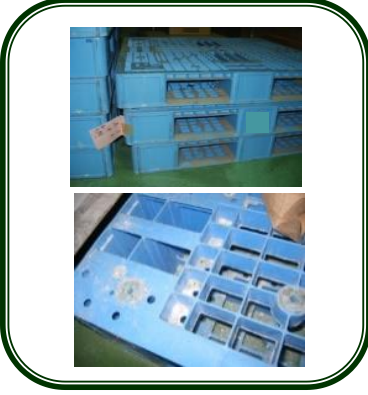
清掃不足のパレット
